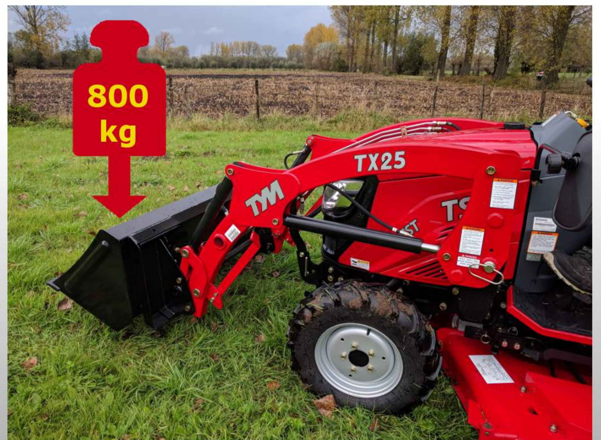
Optie frontlader met zweefstand: +2.000€* Heft 800kg, 1,75m hefhoogte + bak 1,30m met skidsteer snelwissel.
