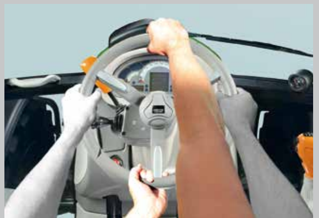
Het SDD-snelstuursysteem. De helft minder stuurwiel draaiing, dubbel zoveel stuurkracht.
