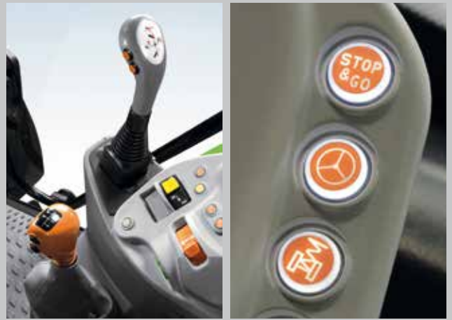
Voorladerjoystick met Powershift-knoppen. Stop&Go, SDD-snelstuursysteem...
