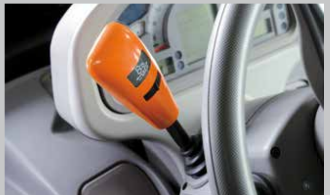
Standaard uitgerust met Powershuttle. Elektrohydraulische omkeerinrichting met regelbare 5-faseninstelling
