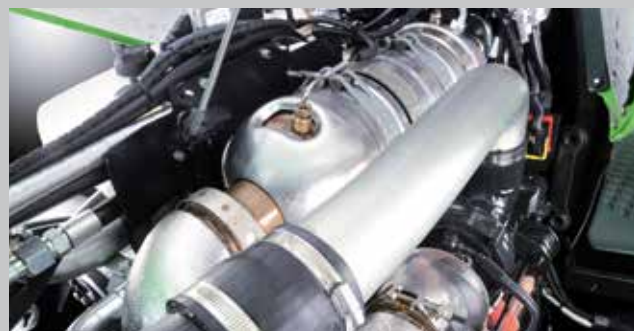
... en een diesel oxidatiekatalysator (DOC) garanderen zeer lage emissiewaarden.
