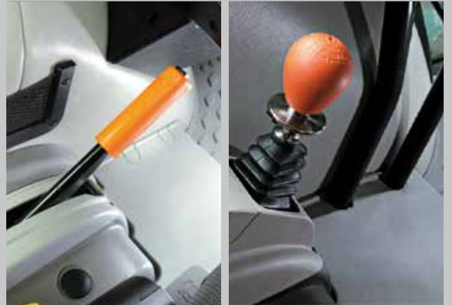
Mechanische of hydraulische parkeerrem . De keuze is aan u.
