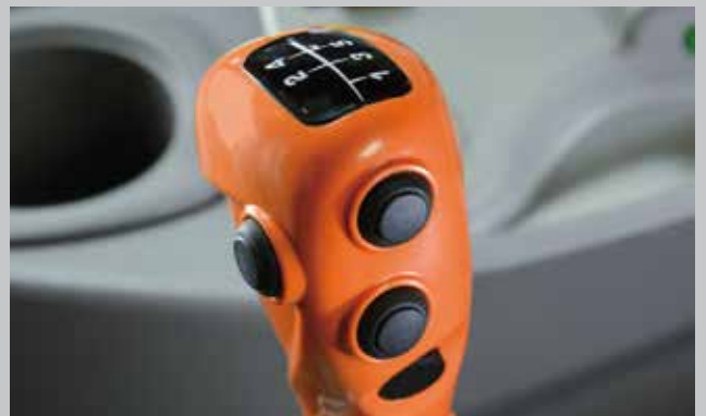
Comfort Clutch en Powershift. Eenvoudigweg schakelen met een druk op de knop, zonder het koppelingspedaal te gebruiken.
