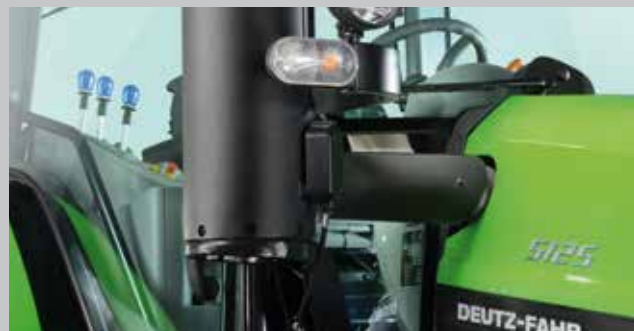
Geavanceerde reinigingstechnologie van de uitlaatgassen, de zgn. selectieve katalytische reductie (SCR) ...
